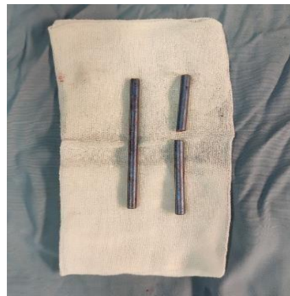
(Gambar 2. Rod sisi patah pada sisi kanan)
